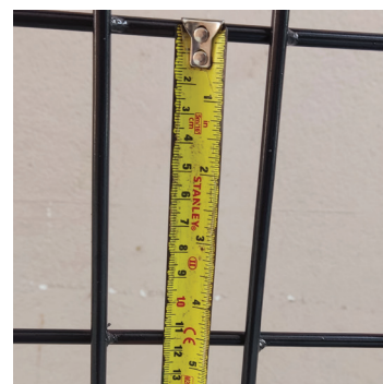
ช่องตะแกรงเหล็ก สูง 11 cm.
