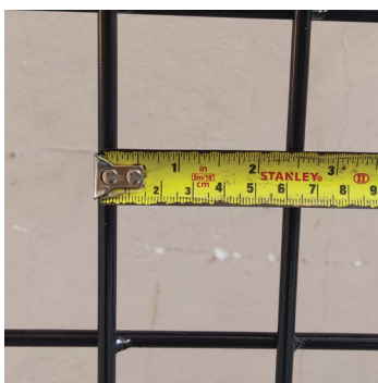
ช่องตะแกรงเหล็ก กว้าง 6 cm.
